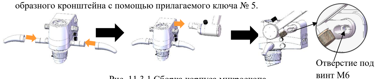
Рис. 11.3.1 Сборка корпуса микроскопа
